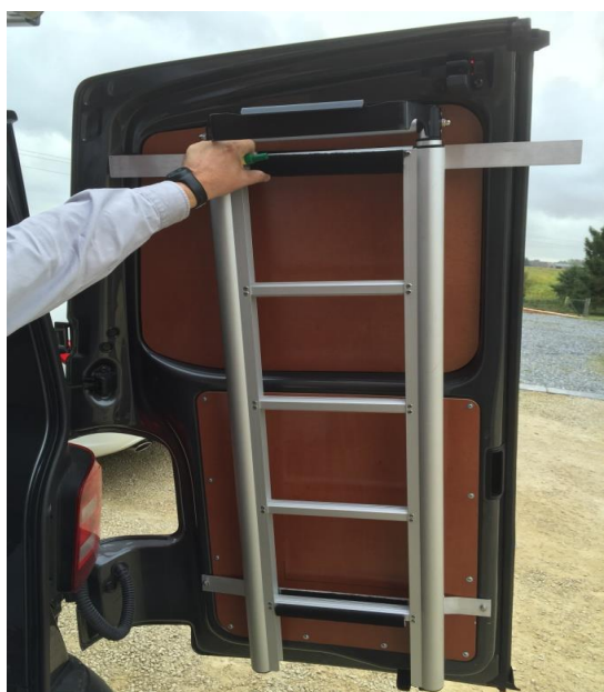
12. Positionner l'échelle et le crochet Haut. Recommencer les Etapes 3 à 11 pour le crochet haut.
