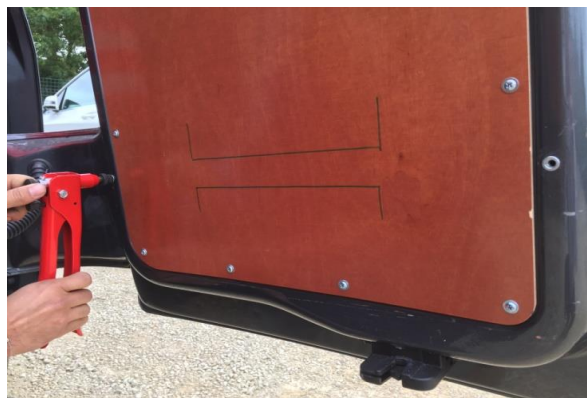
10. Placer les rivets métriques dans la carrosserie
