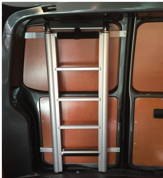
15. Refermer la portière et vérifier que la pose de l'échelle est correcte.
